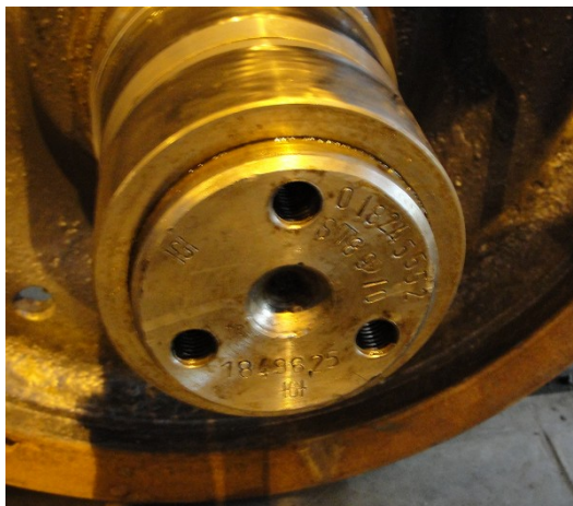
Zestaw kołowy z uszkodzonym nakiełkiem
