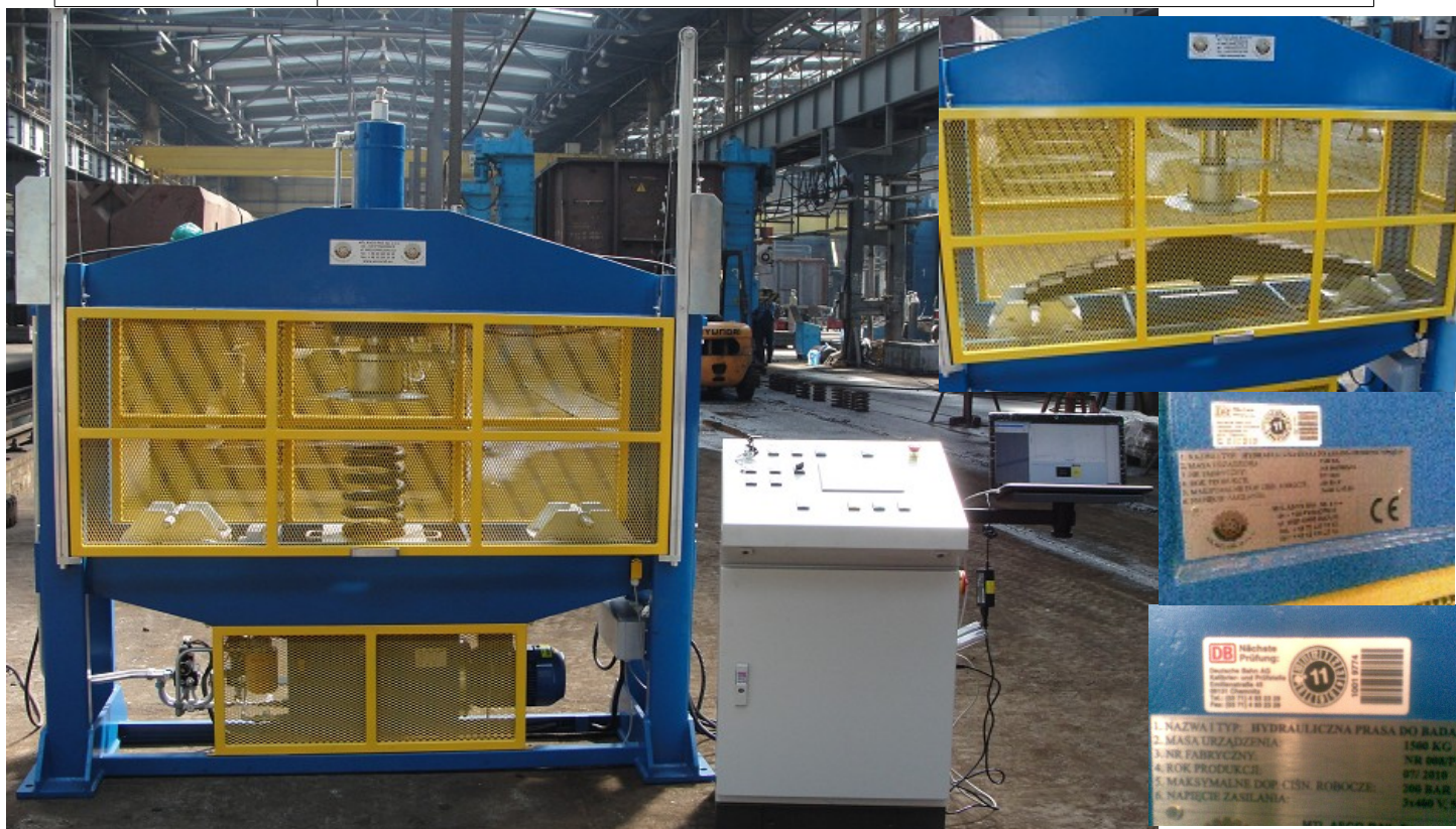
Rys. 1 Prasa ze zintegrowanym w konstrukcji układem hydraulicznym
