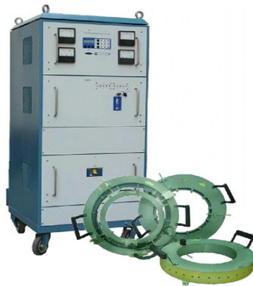
Urządzenie do indukcyjnego nagrzewania piast kół bosych oraz piast dużych kół zębatych.
