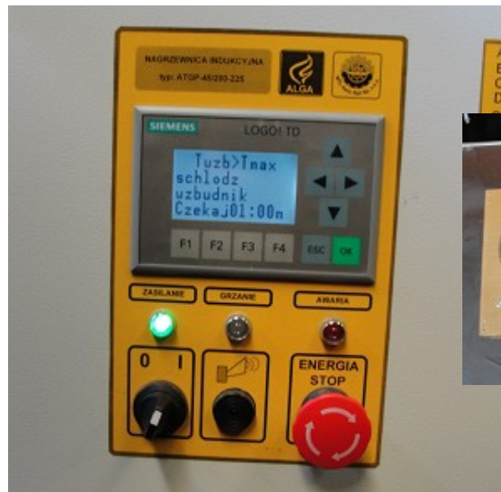
Urządzenie do indukcyjnego nagrzewania pierścieni łożyskowych i labiryntów zestawów kołowych z funkcją rozmagnesowania.
