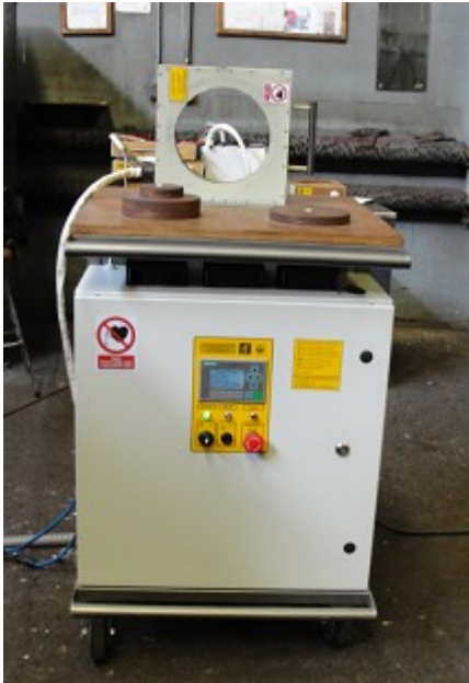
Urządzenie do indukcyjnego nagrzewania pierścieni łożyskowych i labiryntów zestawów kołowych z funkcją rozmagnesowania.
