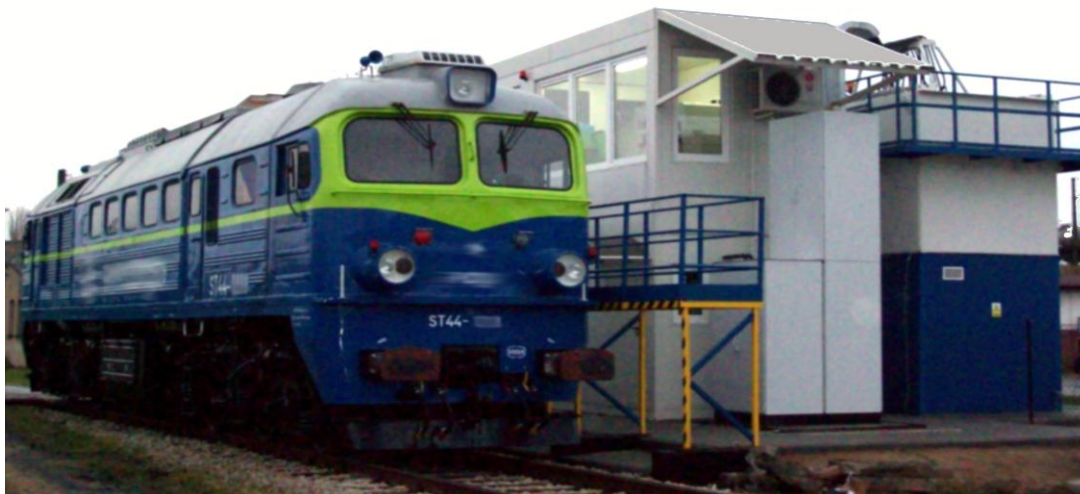
Локомотив М-62 установленный для испытаний на диагностической станции.
