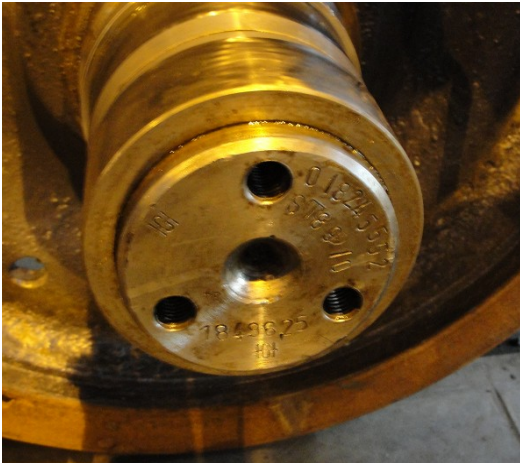
Radsatz mit beschädigter Zentrierbohrung
