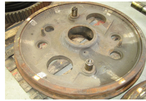
Abpressen des Radsatzes von Alstom
