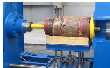
Aufpressen der Welle vom Rotor
