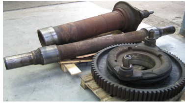
Abpressen des Radsatzes von Alstom
