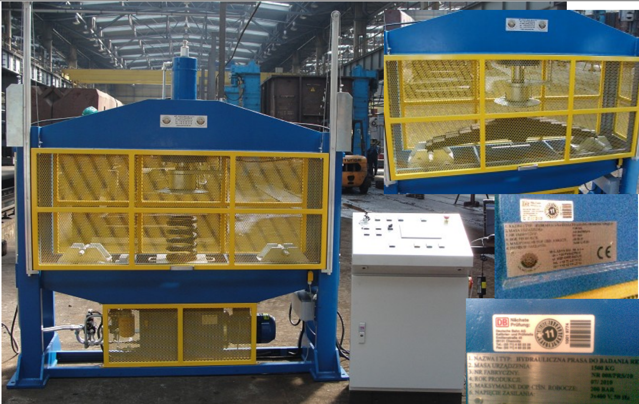
Zeichn. 1 Die Presse mit in der Konstruktion integriertem Hydrauliksystem.
