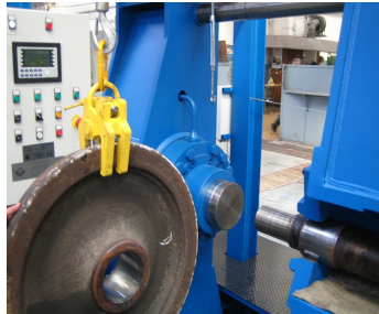
Abpressen des Radsatzes von Alstom
